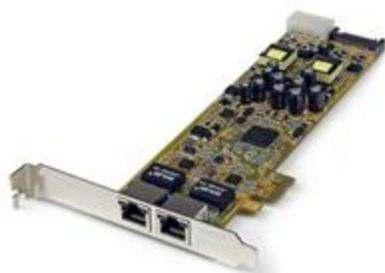
Die Dual Port PoE NIC ST2000PEXPSE bietet zwei 10/100/1000 Mbit/s PoE RJ45-Ports, die jeweils bis zu 25,5 W Strom liefern können und eine Netzwerkdatenverbindung und Stromversorgung über ein einziges Kabel bieten, sodass weniger Kabelsalat entsteht und die Installationen an entfernten Standorten vereinfacht werden.
