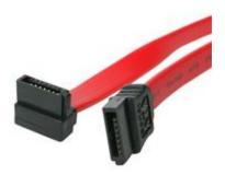
Das rechtsgewinkelte (90-Grad) SATA-Kabel SATA18RA1 verfügt über eine standardmäßige (gerade) SATA-Buchse und eine rechtsgewinkelte SATA-Buchse und bietet eine einfache 45 cm lange Verbindung mit einem Serial ATA-Laufwerk mit Unterstützung der vollen SATA 3.0-Bandbreite von bis zu 6 Gbit/s bei Verwendung mit SATA 3.0-konformen Laufwerken.
