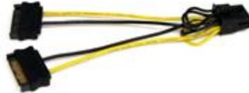
Das SATA-auf-PCI Express-Videokarten-Stromadapterkabel SATPCIEX8ADP bietet einen 8-poligen PCI Express-Stromanschluss (Buchse) und zwei 15-polige SATA-Stromanschlüsse (Stecker) und ist somit eine kostengünstige Lösung zum Anschließen einer PCIe-Videokarte an Serielle ATA-Stromanschlüsse einer Computerstromversorgung, sodass die Stromversorgung nicht wegen Videokartenkompatibilität aufgerüstet werden muss.
