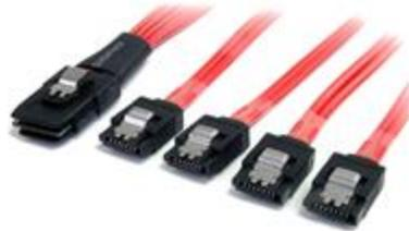
Das SFF-8087-auf-4x SATA-SAS-Kabel SAS8087S450 verfügt über einen 36-poligen Stecker (SFF-8087), der sich in vier 7-polige SATA-Aufnahmen auffächert und eine zuverlässige Lösung zum Anschließen von bis zu vier SATA-Festplatten an einem SAS-Controller oder Backplane bietet.
